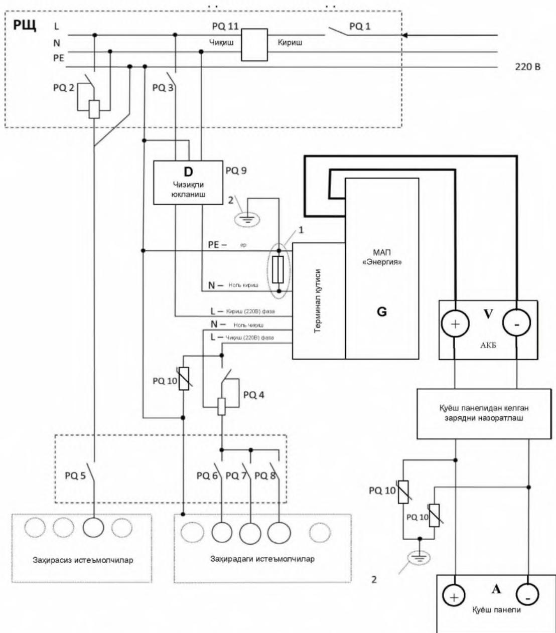
Бу ерда: PQ1-бир фазали киритувчи автомат; PQ2-УЗО билан автоматик виключатель ёки дифференциал автомат; PQ3-автоматик виключатель; PQ4-УЗО билан автоматик виключатель ёки дифференциал автомат; PQ5-PQ8-бир фазали автоматлар; PQ9-ЭМП босиб турувчи фильтр; PQ10-(УЗИП) электр қучланишининг хаддан ташқари кўпайишидан ҳимояловчи қурилма; PQ11-(УЗМ) кўп функционалли ҳимоялаш қурилмаси; PЩ-тақсимловчи ичит.
