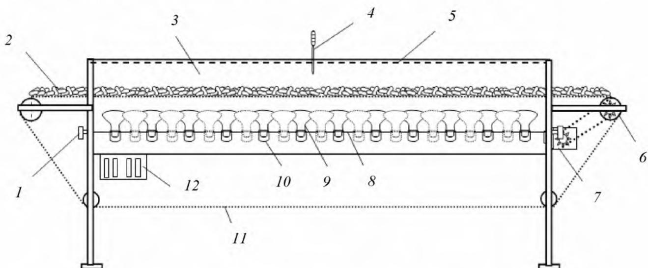
**Рис.3. Технологический чертеж нового устройства для морки живой куколки шелкопряда под воздействием инфракрасного излучения**
