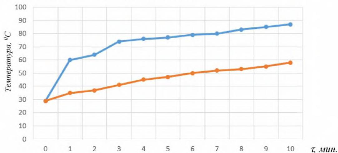
**Рис.5. График изменения температуры кокона и оболочки во времени (при расстоянии между коконом и лампой 8 см);**
