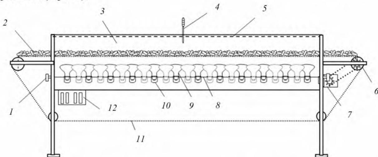
Бу ерда. 1-рамани вертикал ростлаш учун болт; 2-тирик пиллалар; 3-камера; 4-психрометр, 5-кўзгули ойна; 6-вал; 7-конвейерни ҳаракатлантирувчи электродвигатель; 8-конвейер орасига ўрнатилган рама; 9-тўлқин узунлиги 1,1 мкм бўлган инфрақизил (ИКЗ 215-225-250-2, 250Вт) лампани иситиш элементлари; 10-керамик патрон; 11-конвейер; 12-электр шит;
