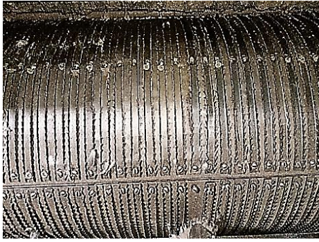
Рис. 1. Состояние сегментов пилы, потерявших работоспособность
