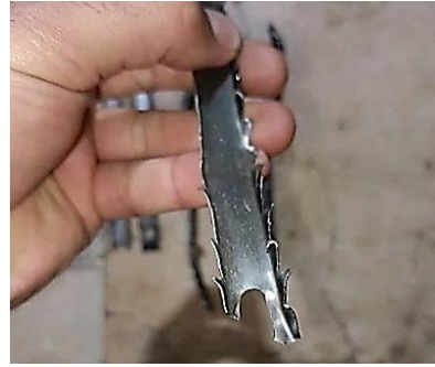
Рис. 1. Состояние сегментов пилы, потерявших работоспособность
